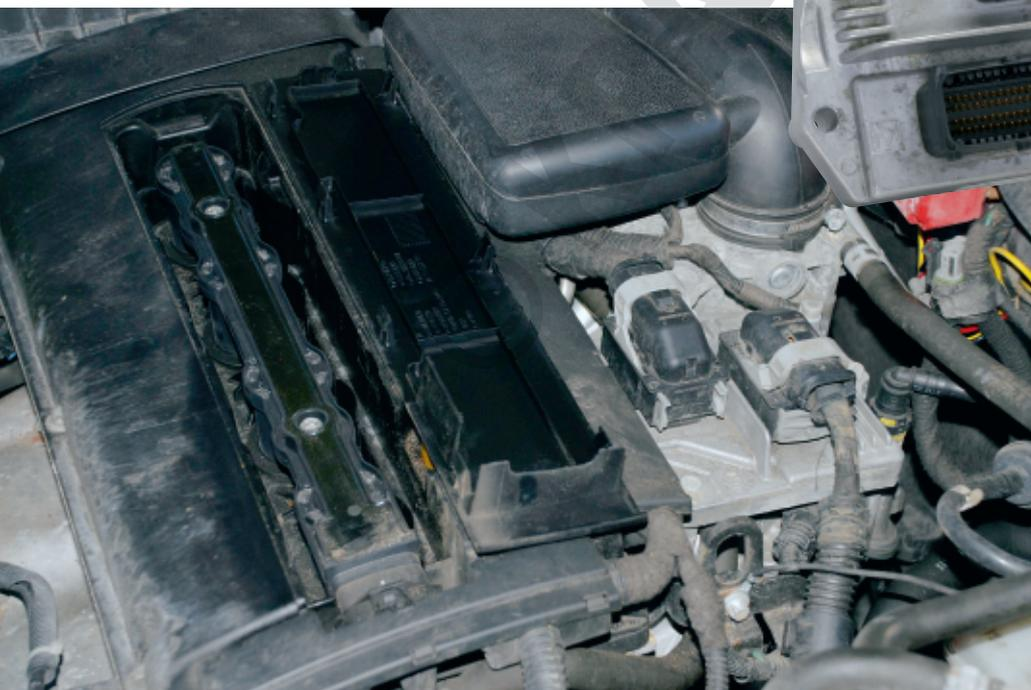
**Systematisch vorgehen:** Wie die Praxis zeigt, führt bei bestimmten Fahrzeugmodellen ein defektes Zündmodul unter Umständen zum Fehlerspeichereintrag ‚Steuergerät defekt‘. Dabei kann, aber muss das Steuergerät nicht zwangsläufig durch ein fehlerhaftes Zündmodul beschädigt sein, auch wenn das der Fehlereintrag suggeriert. Bild: Schmidt, Glaubitz
