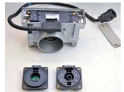
Verschlossene Drosselklappen ersetzt ecu.de mit einer eigenen Hall-Variante.
