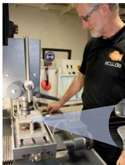
Ist der Fehler lokalisiert, wird das Steuergerät geöffnet. Hierzu muss in diesem Fall das Alu-Gehäuse präzise aufgefärs werden.
