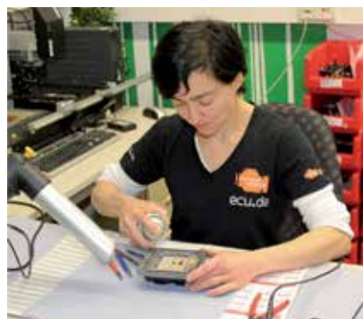
Als Nächstes wird eine eventuell aufgebrauchte Beschichtung („Gelee“) sorgfältig entfernt und die Platine gereinigt.
