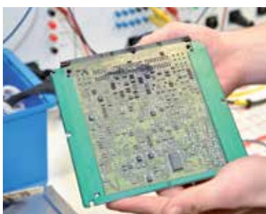
Die Ausnahme: Immer seltener erkennt man Platinendefekte wie diese „Brandstelle“ mit bloßem Auge.
